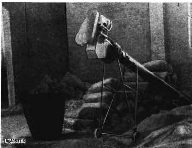
Bild 6. Schneckenförderer vom VEB Mühlenbau Dresden
