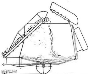
Bild 5. Förderkette zum Einbringen des Strohpolsters hochgestellt
