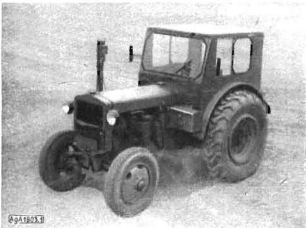
Bild 1. RS 01/40 „Pionier“ 40 PS (Daten siehe Tafel 1 und 4). Kennzeichnend für den Stand der deutschen Serienfertigung bis 1944
