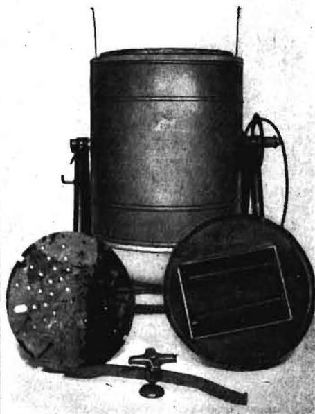
Bild 3. Das Bild zeigt die Innenansicht des Deckels mit der Wasserpfanne und den Heizröhren. Der gelochte Rost, mit dem die Kartoffeln abgedeckt werden, soll verhindern, daß diese beim Kippen in die Heizwanne fallen.
