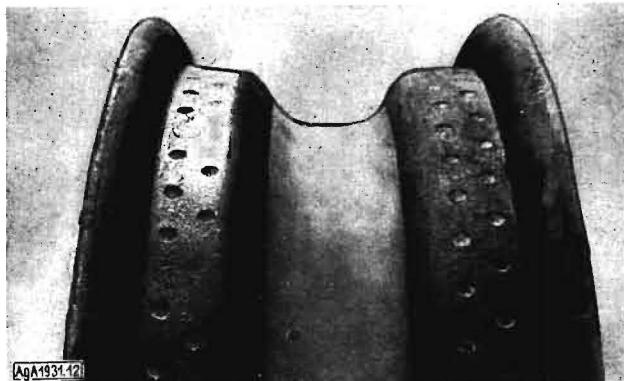
Bild 12. Der angebohrte Felgenfuß verhütet das „Reifenwandern“ bei abgesenktem Luftdruck
