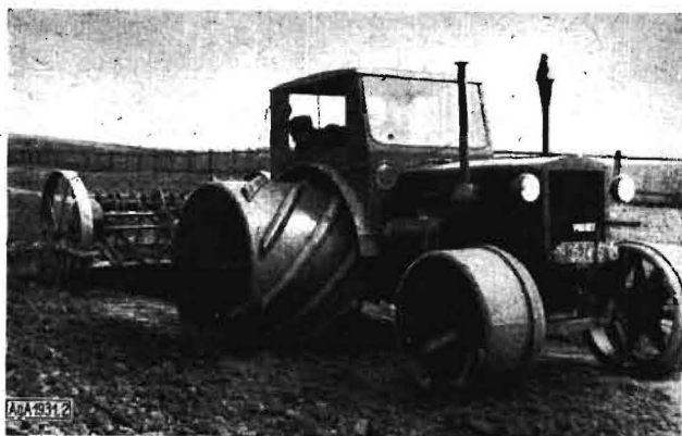
Bild 2. Mit Moorverbreiterungen ausgerüsteter „Pionier“ bei der Saatbettvorbereitung
