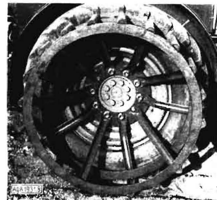
Bild 8. „Blindlöcher“ im Radflansch des Gitterrades ermöglichen eine unfallsichere Montage
