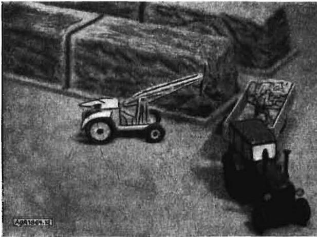
Bild 12. Schlepper mit Frontlader als Dungkran
