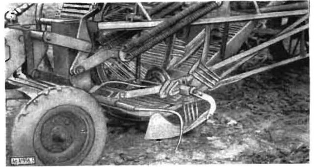
Bild 5. Zapfwellengetriebener Wurfgabelroder in Kombination mit einem Vorradsroder
