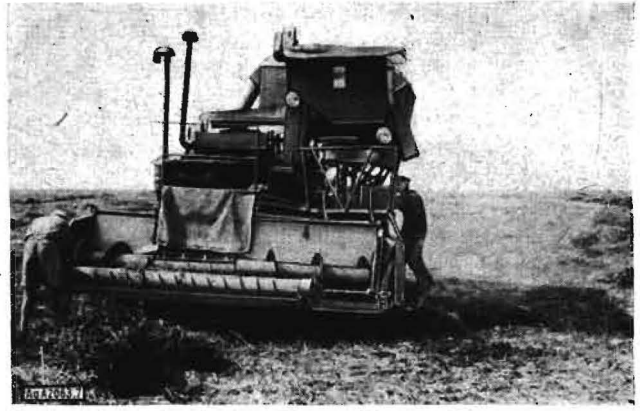
Bild 7. S-4 mit Aufnahmewalze für Schwaddrusch
