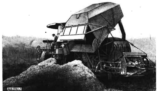
Bild 2. S-4/3 m bei der Entleerung des Spreubunkers
