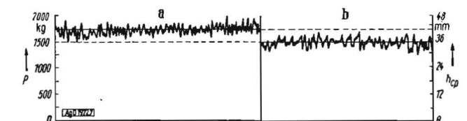
Bild 7. Zugwiderstand des Pfluges PS-30 auf einem Gerste-Stoppelfeld (beim Herbststurz) a ohne Elektroosmose; b mit Elektroosmose
