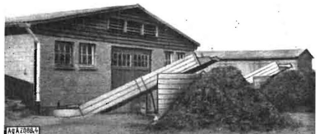
Bild 4. Ausräumen der Dünggrube mittels Hochförderer
