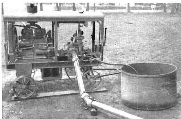
**Bild 1.** Saugseite eines fahrbaren Pumpenaggregats 100 m<sup>3</sup>/h Fördermenge und 60 m manometrische Förderhöhe mit 40-PS-Dieselmotor sowie Anschluß für Nährstoffverregnung mit Kunstdünger-Mischbehälter. Saugleitung aus Formstücken und Schnellkuppelungsrohren zusammengesetzt. (VEB Rohrleitungsbau Bitterfeld)
