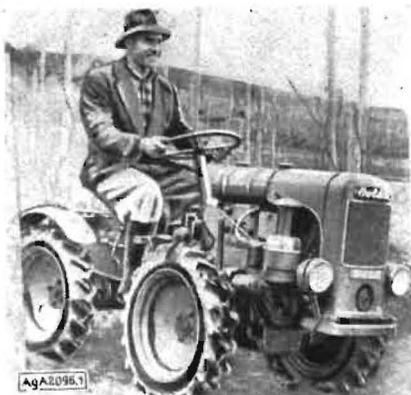
Bild 1 (links). Allrad-schlepper (Holder)
