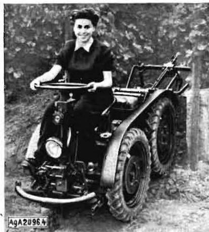
Bild 4. „Varimot“ Allraddiesel (Variwerk)
