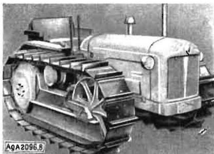
Bild 8. „Fordson“ Diesel-Kettenschlepper 40-PS
