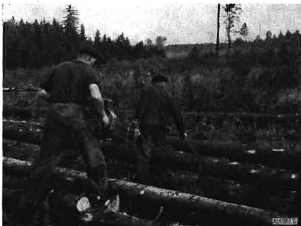
Bild 10. Tragen der Zweimann-Motorkettensäge
