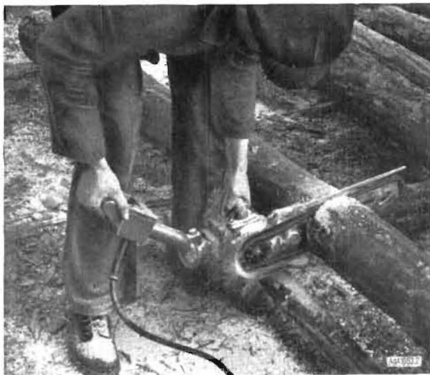
Bild 2. Arbeitsbewegung am vorwiegend einarmigen Hebel
