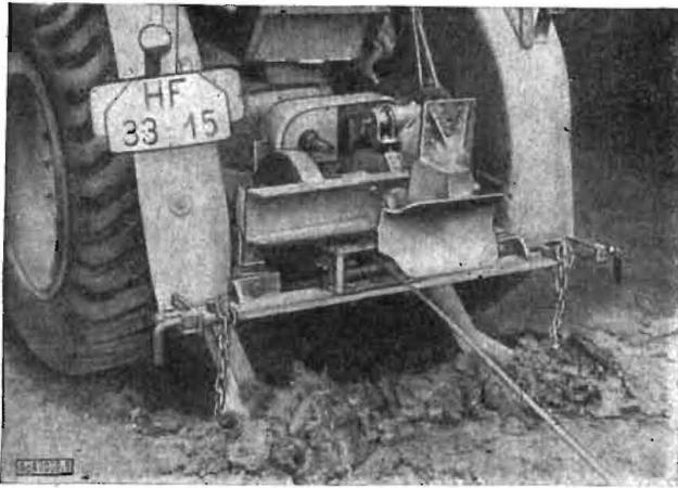
Bild 9. Rollenseilführung und Standsicherung durch Bergstütze
