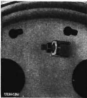
Bild 21 (links). Bajonettschnellverschluss mit Rücklaufsicherung durch Befestigungsschraube
