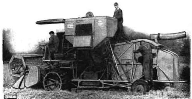
Bild 1. Mähdrescher E 171 (Weimar) mit Verbesserungen des Kollektivs Löderburg: Gitterräder, verlängerte Fallbleche, Griffe am Dreschwerk (Foto: Fritz Hohm, Rothenförde)
