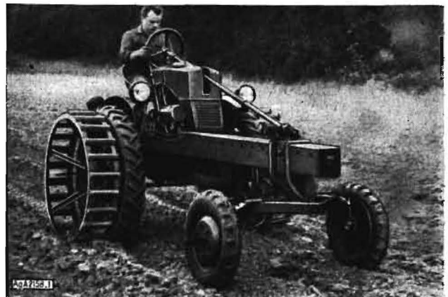
Bild 1. RS 08/15 — Geräteträger „Maulwurf“ mit Giterrädern
