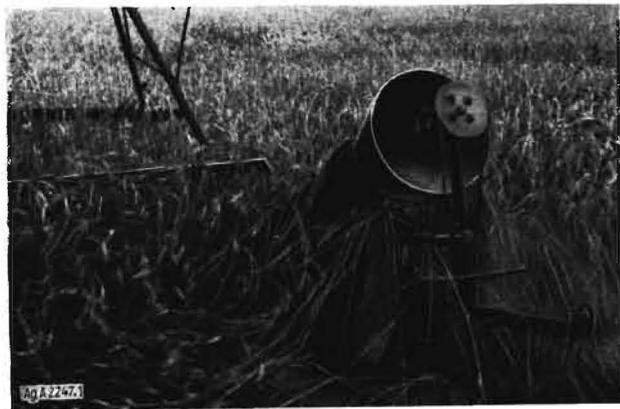
Bild 1. Der rotierende Halmteiler leistet eine sehr gute Arbeit. Der Antrieb mittels endlosen Rundriemens zeigte aber oft Störungen und Ausfälle
