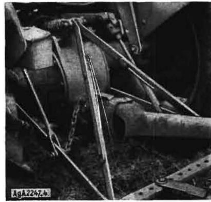
Bild 4. Gute Lösung eines Zapfwellenschutzes
