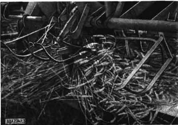
Bild 3. Die größte Schwäche des Flachbinders ist die schlechte Lagerung des Erntegutes auf dem Bindetisch. Ohne bessere Ausführung der Haltefedern und Anordnung von Halteklappen werden die Halme in der Mitte geknickt
