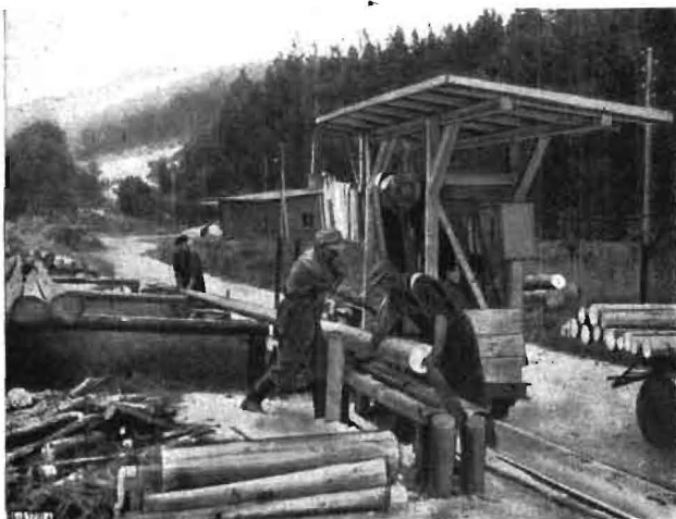
Bild 4. Einschneiden von Langrohholz zu Schichtholz auf Holzausformungsplätzen. Das Langrohholz wird von der Ablage der Säge zugeführt und das Schichtholz auf Wagen abgelegt.
