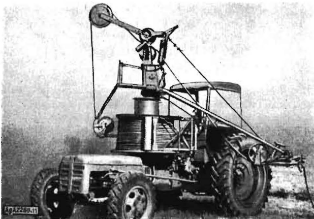
Bild 11. Elektroschlepper mit stehender Kabeltrommel
