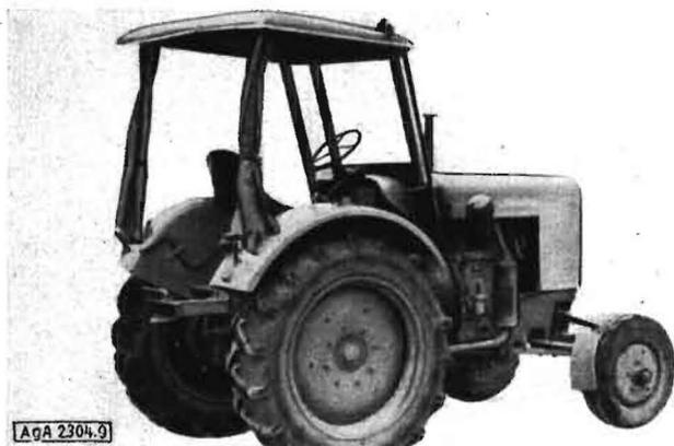
Bild 9. Fendt-Schlepper mit Fahrerkabine in Leichtbau-Rohraustrüstung
