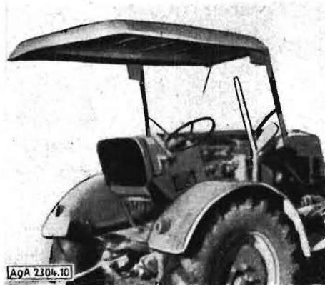
Bild 10. Fritzmeier-Fahrerkabine mit freischwebendem Dach
