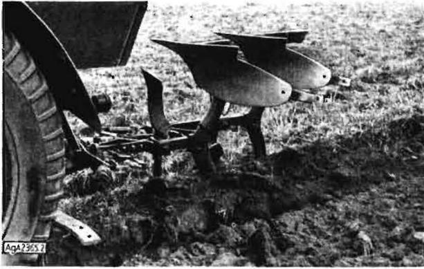
Bild 2. Anbaudrehpflug für RS 04/30 in Erprobung
