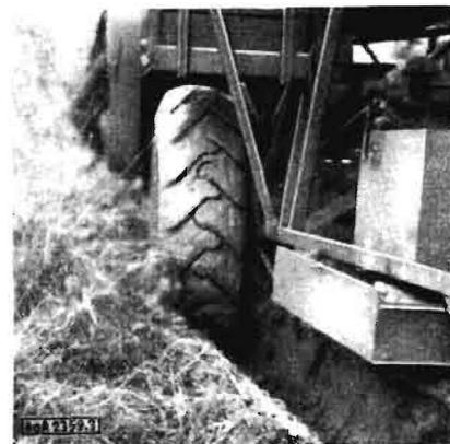
Bild 1, 2 und 3. Geänderte Vorderachse bei der Gewalterprobung von täglich 8 Stunden, davon 15 bis 20 Minuten Wühlarbeit des Getriebes und der Vorderräder in eingesunkenem Zustand
