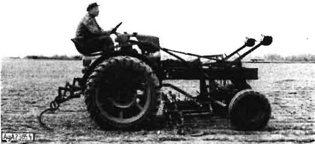
Bild 4. Rübenverhackgerät Typ P 101 in Erprobung
