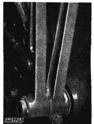
Bild 5. Anordnung des Zugpendels beim sowjetischen „Belarus“
