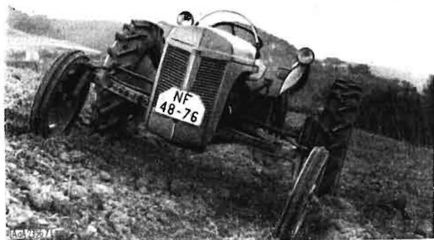
Bild 7. Arbeitsversuche mit „Breitspur“ bei 40% Hangneigung. Über der Motorhaube ein einfacher Neigungsmesser sichtbar
