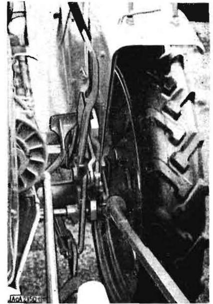
Bild 1. Kegeltrieb an der Hinterachse des Fendt-Geräteträgers
