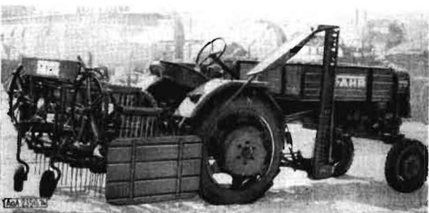
Bild 14. „Geräte-Trak“ mit Mähbalken, Ladepritsche und „Schnellheuer“
