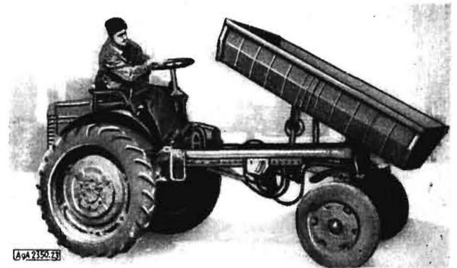
Bild 23. Sowjetischer Geräteträger „SSch-14“, 14 PS, mit Ladepritsche
