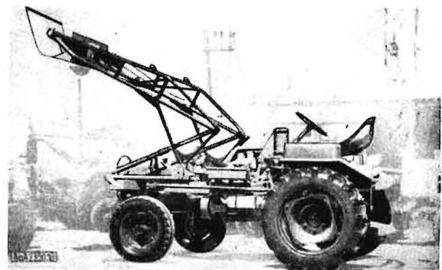
Bild 10. „Multitrak mit Frontlader
