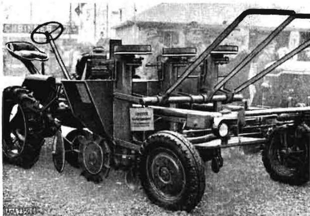
Bild 6. Lanz-ALLDOG mit dreireihiger Kartoffellegemaschine
