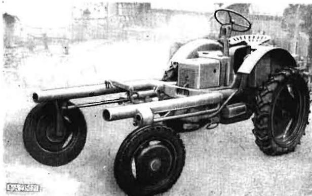
Bild 21. Geräteträger der Rotenburger Metallwerke, 8 PS
