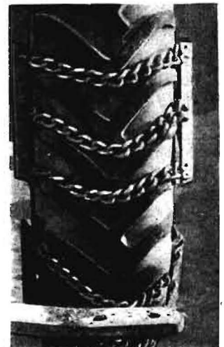
Bild 8. Ackerschlepper-Triebradreifen zusätzlich bestückt mit Schneeketten
