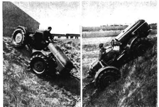
Bild 6. Allradschlepper der Bayerischen Traktorenwerke mit guter Steigfähigkeit und sicherer Fahrtrage bei der Abwärtsfahrt
