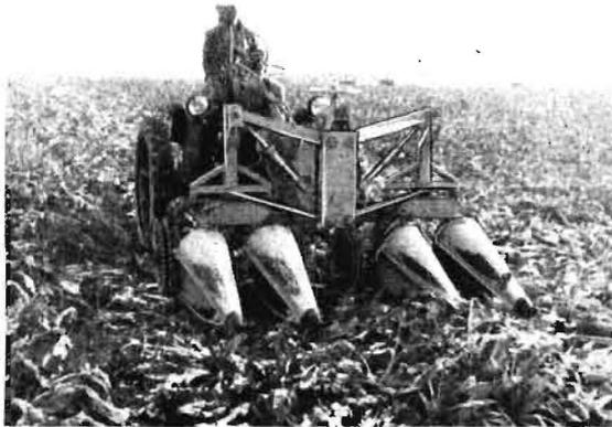
Bild 5. Sechsstufiger Anbaukopf zum RS 08/15
