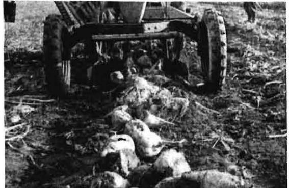
Bild 11. Rübenerladeband zum RS 08/15 im Einsatz
