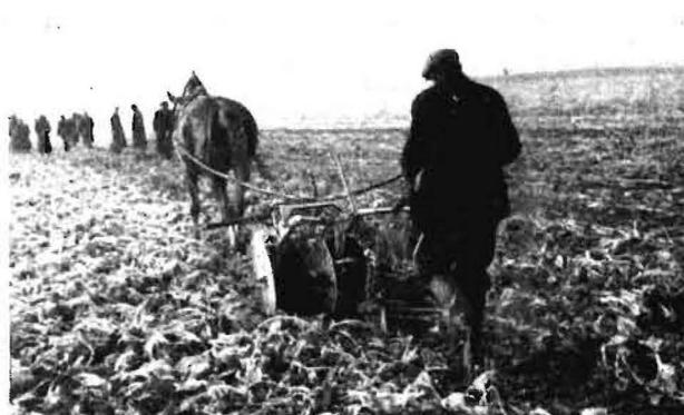
Bild 3. Dreireihiger Gespannköpfschlitten
