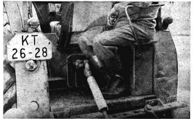
Bild 1. Die Zapfwelle, der Gefahrenherd Nr. 1 in der Landwirtschaft
