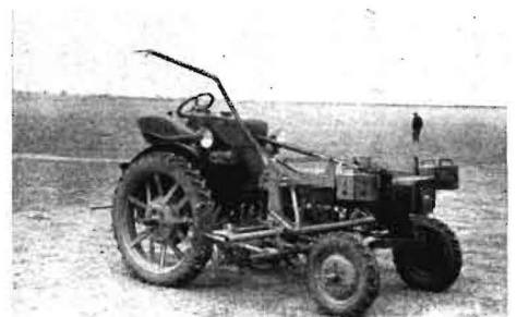
Bild 5. Anbau-Ausdünnmaschine P 101 zum RS 08/15; sechsheilig (für Reihentfernungen von 40 bis 50cm), durch vordere getriebegebundene Zapfwelle angetrieben
