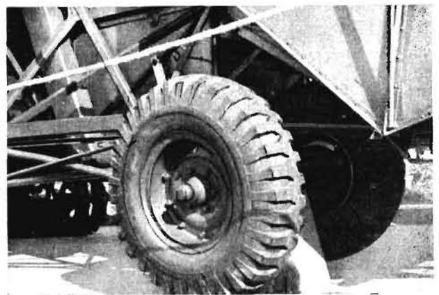
Bild 2. Größeres Lenkrad am S-4
