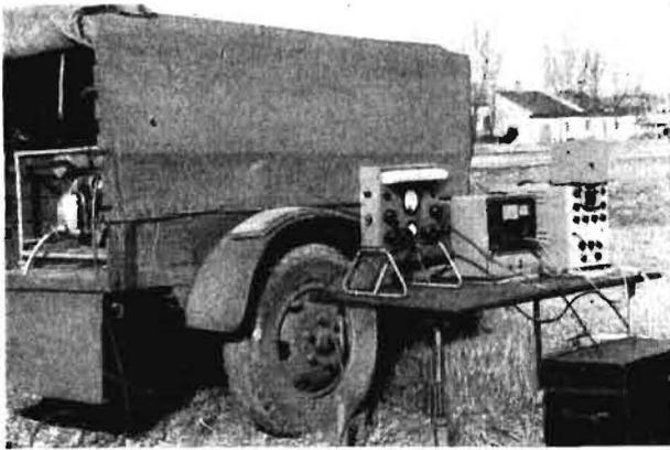
**Bild 1.** Der Meßwagen und die Registrierapparate für das Messen von Dehnungen mit Dehnungsstreifen. Im Wagen ein Motorgenerator. Bei Messungen auf dem Felde ist der Meßrohr durch ein geschirmtes Kabel mit dem Pflug verbunden
