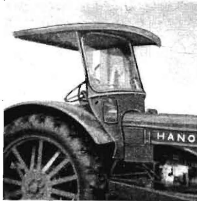
Bild 13a. Fahrerterverdeck mit vorgeschobenem Dach
