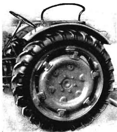
Bild 8a. Momentenpurverstellung am Triebdrab des 18-PS-Schleppers von KLOCKNER-HUM-BOLDT-DEUTZ
