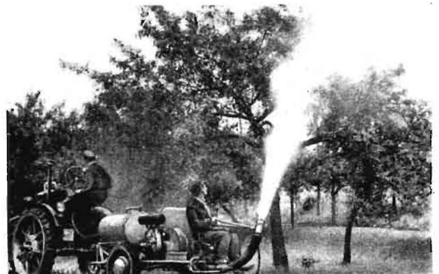
Bild 3. Sprühblaser S 881 im Einsatz (Stäuben)
