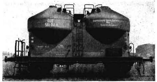
Bild 1. Behälterwaggon für staubförmige Massengüter, System Klinger, Lieferwerk VEB Waggonbau Niesky
