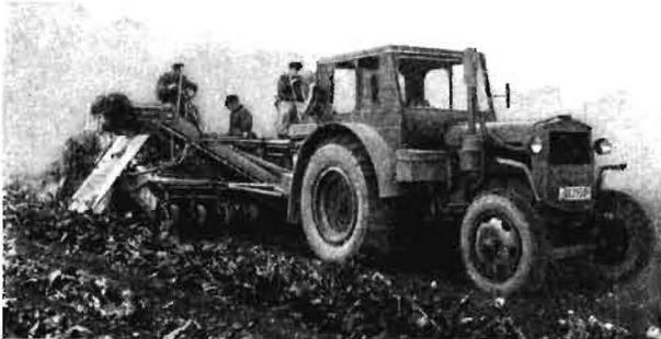
Bild 4. Rübenvollerntemaschine
