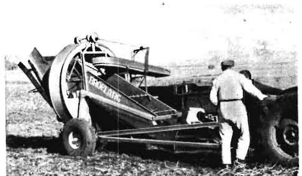
Bild 3. Fabrikkartoffel-Sammelroder „Broelang“ (Niederlande)
