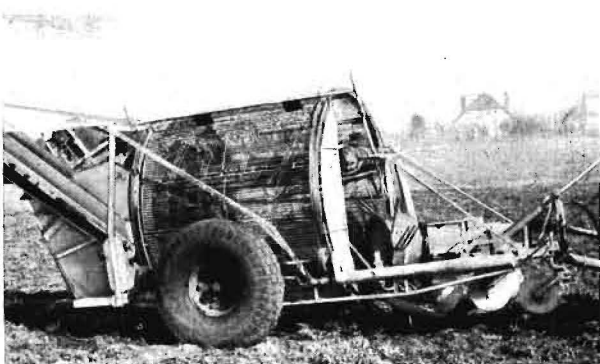
Bild 2. Siebtrommel-Sammelroder „Climax“ (Niederlande)
