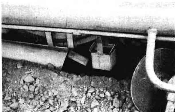
Bild 10. Schwenkbare Häufelscheiben decken die Kartoffeln zu und bilden gleichzeitig Dämme
