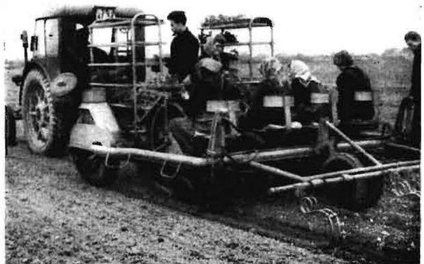
Erdballen lassen sich in die Becher verschiedene Einsätze hineinstecken, um der Pflanze beim Aussetzen eine gute Führung zu geben.
