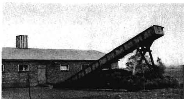
Bild 14. Entmistungsanlage SVALÖF. Die Schlepplschaufel hat die Öffnung im Schrägförderer passiert, der Mist fällt auf die Dungstätte
