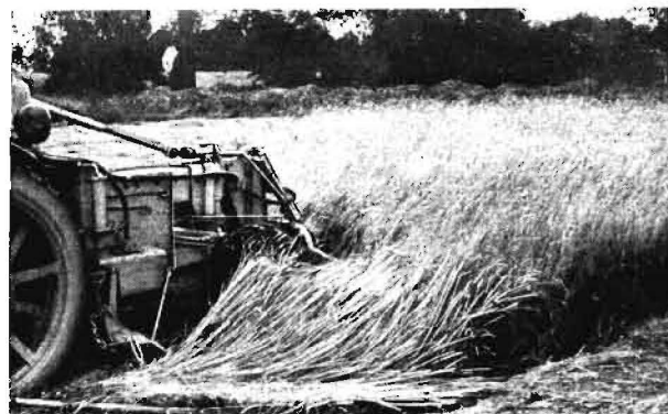
Bild 6. Schlechter Abfluß des Mähgutes von dem Mähbalken infolge zu geringer Arbeitsgeschwindigkeit
