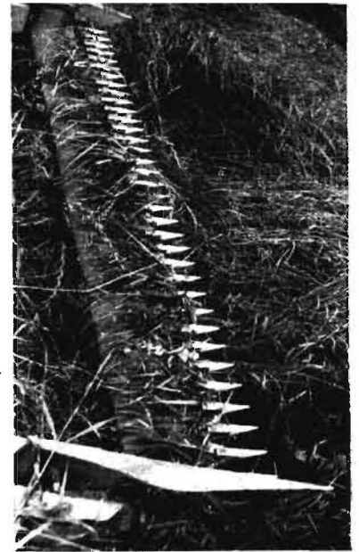
Bild 7. Verklebter Frontbalken infolge zu geringer Arbeitsgeschwindigkeit
