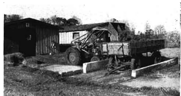
Bild 31. Schweinegroßmästerei in STORA-BERNSTORP bei Malmö. Der Schlepper schiebt mit dem Frontlader den Kot aus dem Stall heraus und lädt ihn auf den bereitstehenden Dungwagen
