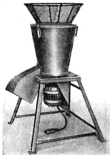
Bild 2. Futtermuser (VEB Landmaschinenbau Barth)
