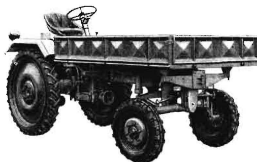
Bild 2. Hofschlepper RS 27 mit Ladepritsche nach vorn und beiden Seiten hydraulisch kippar
