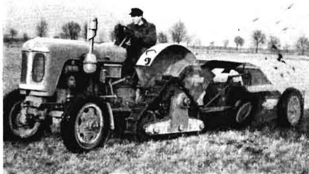
Bild 5. RS 14/30 mit Halbraupe und angehängter Wittenburgfräse
