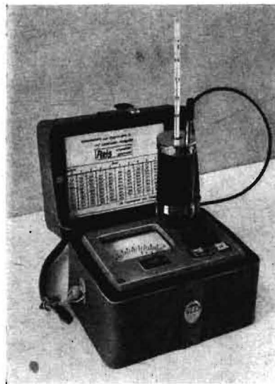
Bild 1. „Hygromette“ mit Elektrodenmeßgefäß
