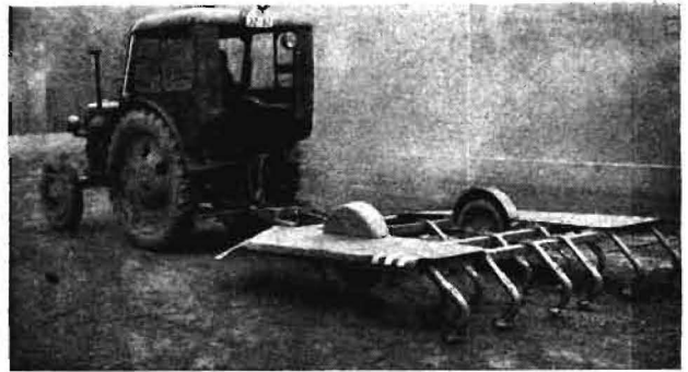
Bild 15. Hydraulisch betätigter Obstbaugrubber in Arbeitsstellung
