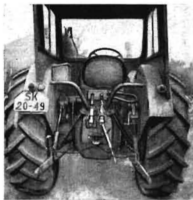
Bild 18. Rückansicht des RS 01/40 „Pionier“ mit Anbau-Dreipunktaufhängung und Schlauchkupplungen für hydraulisch betätigte Anhängegeräte in Versuchsausführung
