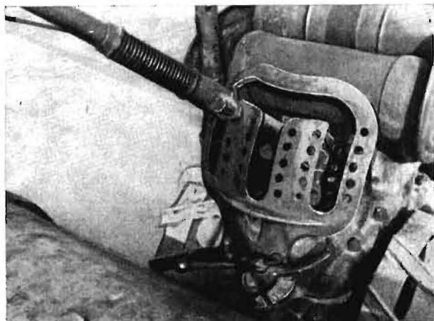
Bild 1. Lenkmechanik an alter SIMAR-Fräse 8 PS
