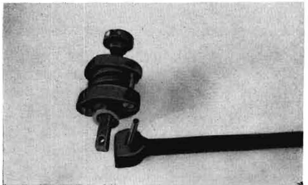
Bild 6. Federkissen mit eingeschobenem Spannbolzen, einbaufertig
