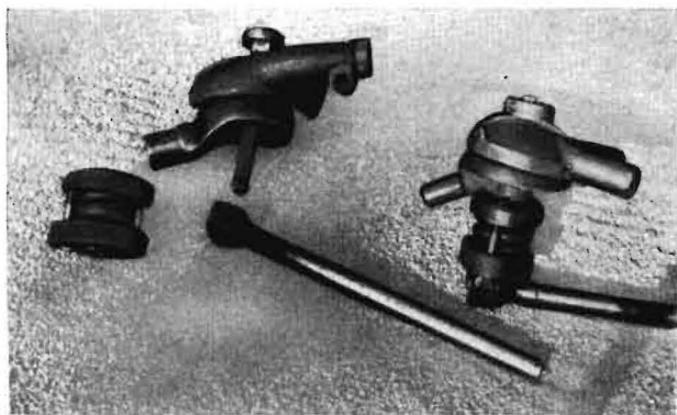
Bild 7. Links: Holmpilz (ohne Mittelholm) für H 3 mit Kugelpfanne (ohne Griffholme) vor dem Zusammenbau; rechts: das gleiche für DUZ Typ 22, zusammengebaut
