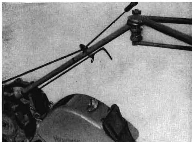
Bild 8. Spannkissen in Motorhacke DUZ Typ 22, eingebaut
