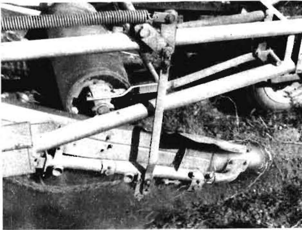
Bild 5. Aufnahme des Bodens durch die Schare und Tätigkeit der vorderen Klutenwalze auf schwerem Boden
