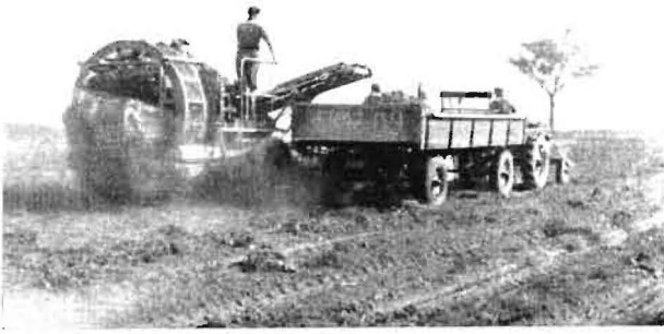
Bild 4. Kartoffelvollerntemaschine im Einsatz
