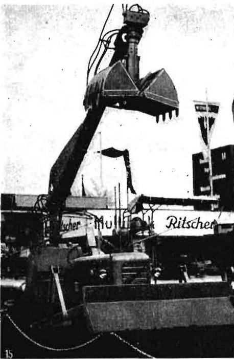
Bild 15. Hydraulisch gesteuerter „Atlas“-Hecklader, auf einem Ritscher-Schlepper aufgebaut
