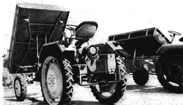
Bild 7. Hofschlepper RS 27; Ladepritschen nach drei Seiten hydraulisch kippbar
