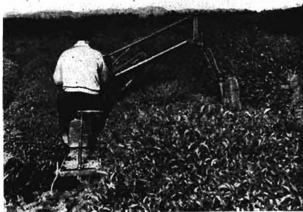
Bild 2. SSCH-8 G beim Grubbern der Zwischenreihen einer auf einem Hang von 25° gelegenen Teeplantage
